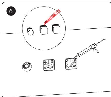
Следуя линии разреза на коробке, отрежьте выступающую часть коробки. После укладки облицовки нанесите водостойкий герметик на край плитки.
