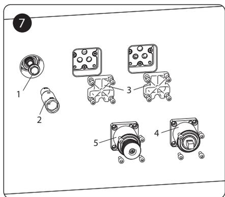
Снимите заглушку (1) с помощью сервисного ключа (2). Установите соединительную трубку держателя ручной лейки. Снимите защитные заглушки картриджа и дивертора (3) с помощью шестигранного ключа. Установите картридж (4) и дивертор (5) и зафиксируйте их винтами на встроенном блоке.
