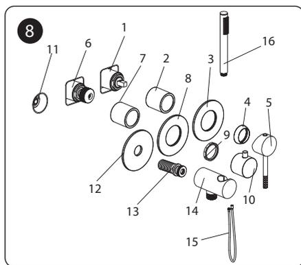
Наденьте декоративные гильзы (2, 7) на картридж (1) и дивертор (6) и зафиксируйте гильзы гайкой (9) и декоративной крышкой (4). Установите декоративные отражатели (3, 8, 12). Установите ручки управления смесителем (5) и дивертора (10), зафиксируйте их винтами. Наденьте держатель лейки (14) на соединительную трубку (13) и зафиксируйте винтом. Прикрутите шланг душа (15) к держателю (14), а ручную лейку (16) к шлангу.
